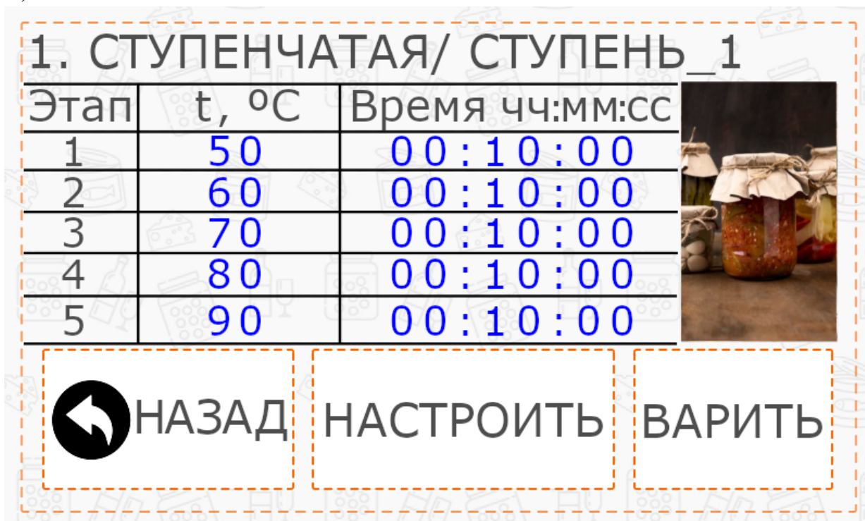
Рис. 21. Меню параметров приготовления режима «СТУПЕНЧАТАЯ».
